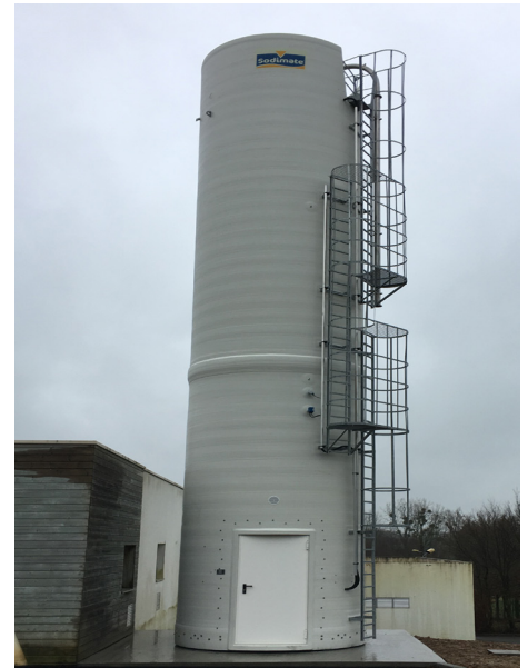
Silo con faldón autoportante
