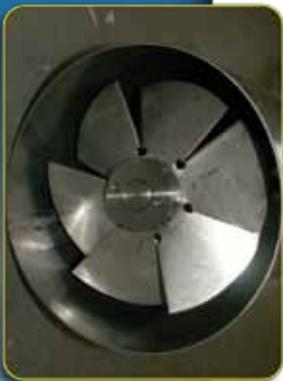
El dispositivo se compone de una tubuladura vertical en la que se instala un agitador de doble hélice, que fuerza la predilución del carbón evitando la formación de polvo.
