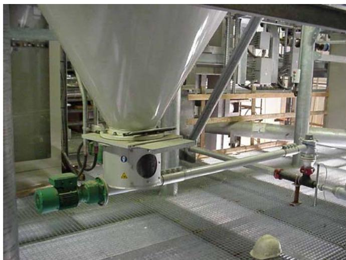
► Exemple d'installation industrielle d'un dévoûteur doseur / Example of an industrial installation of a bridge breaker-feeder (doc. SODIMATE)
